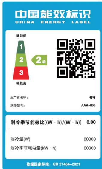
图 1 风冷式单冷型多联机能源效率标识样式示例
