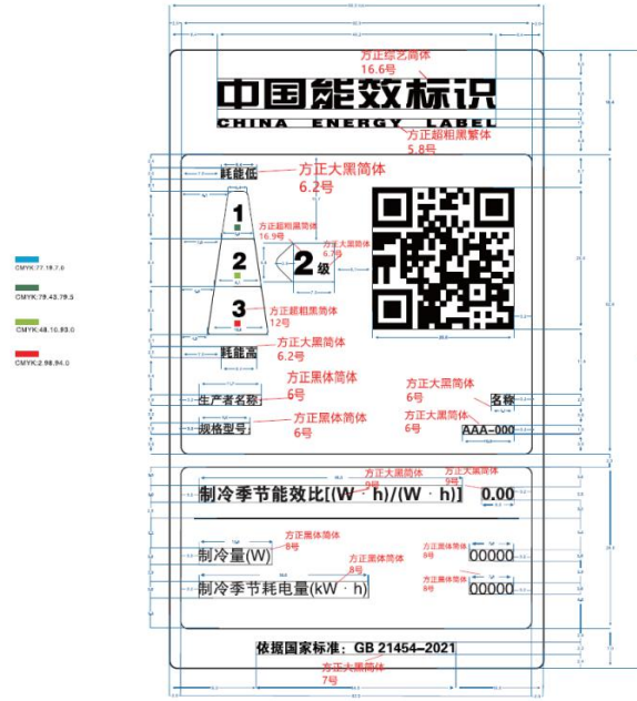
图 1 风冷式单冷型多联机能源效率标识样式示例
