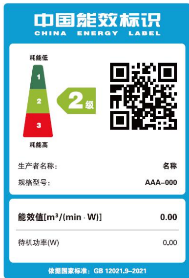
图 1 电风扇能源效率标识样式示例
