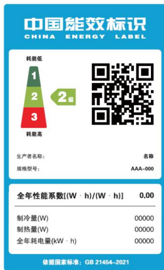
图 2 风冷式热泵型多联机能源效率标识样式示例
