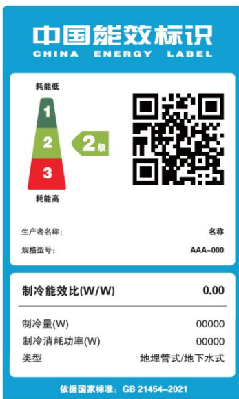
图 3-2 水冷式（地埋管式、地下水式）多联机能源效率标识样式示例
