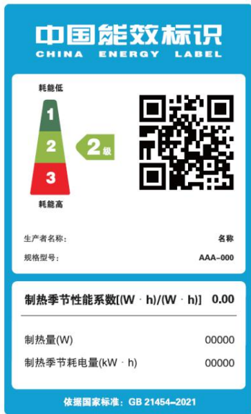
图 4 低温多联机能源效率标识样式示例
